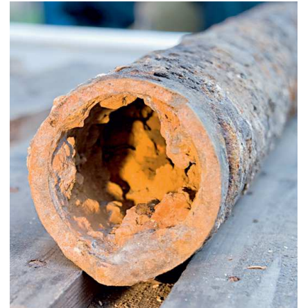
Marode oder verkalkte Wasserrohre sind ein häufiger Grund für Gebäudeschäden.
